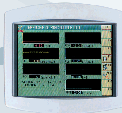
TEST EFICIENCIA CALEFACCION
